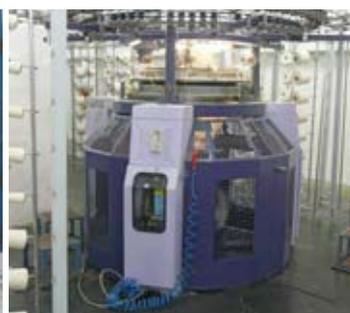
Die Strickmaschine läuft rund um die Uhr und vollkommen automatisch.
