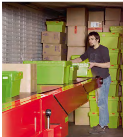
Der Teleskopförderer erleichtert die Beladung des LKW-Containers wesentlich.
