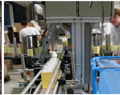
Die Abfüllung und Etikettierung der 300 ml-Pumpspender erfolgt automatisch. Von Hand werden anschließend jeweils sechs Einheiten sorgfältig in Transportkartons verpackt.
