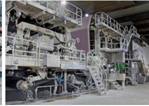
Die Papiermaschine entwässert, glättet und trocknet das Stoffgemisch.
