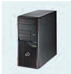
Der Fujitsu Desktop-PC „Esprimo“ wird in Deutschland hergestellt und ist einfach zerlegbar.
